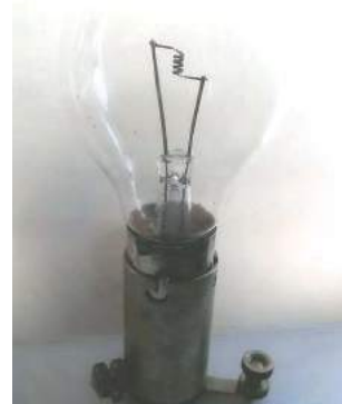
Vue de l'une des très rares ampoules de 250 W sous 24 V et 10,5 A qui existent encore.
